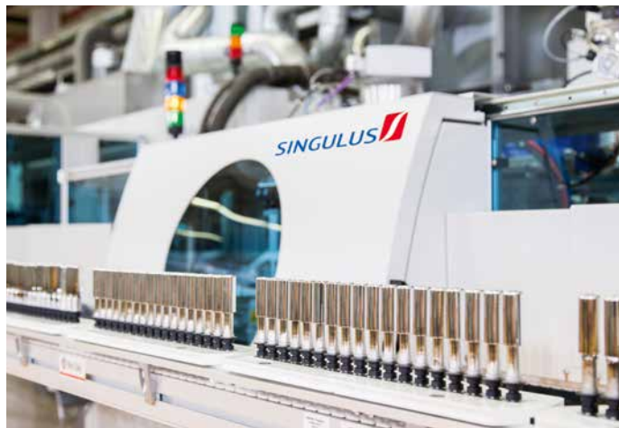
Polycoater – neu entwickelte Vakuum-Beschichtungsanlage für dekorative Formteile, Displays und Touch Panels
